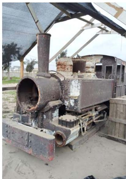
mos el trabajo especializado, el detalle y la obra fina, los niños nos ayudaron con el lado más salvaje; arenar la locomotora para sacar la primera capa de suciedad y óxido, hidrolavar, algunas capas de pintura con neutralizador de óxido y luego pinturas de poliuretano para resistir la intemperie», explica Santiago Gómez.
